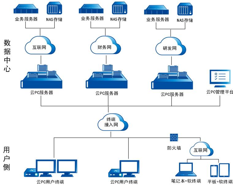
具体实现上，通常会在每个子计算域内部署一组独立的集中计算服务器。例如在内网部署一套 NGCC 服务器集群供内网应用使用，在外网部署另一套 NGCC 服务器供上互联网的需求使用。两套环境各有各的网络和存储，物理上互不相通。用户如果需要同时访问内网和外网，则按原则四/五拥有两个计算实例，分别跑在内网集群和外网集群上。用户的终端可以同时连接这两个实例，通过终端菜单切换或使用双屏幕来并行操作不同安全域的桌面。这样用户体验上相当于两台隔离 PC 同时使用，但实际只用一个终端就实现了，而且数据仍然各自在其域内保存，没有跨网传输。
