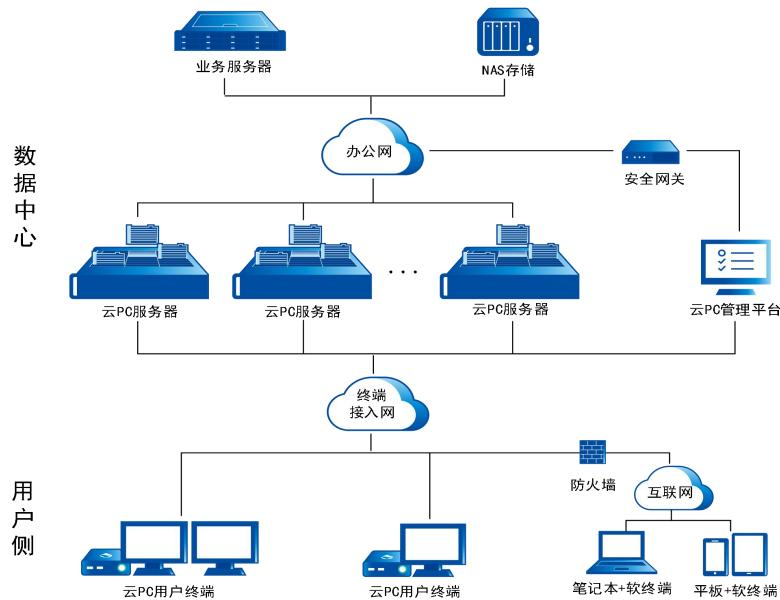
**单数据中心模式**（如上图所示）是 NGCC 最基础和直接的部署方式，适用于组织内部网络环境相对集中统一的情况。在这种模式中，所有 NGCC 服务器（集中计算域）和管理平台都部署在同一个数据中心内，用户无论身处总部还是通过远程网络接入，均连接到该中心的数据中心获取计算服务。终端通常经过网络交换设备直接接入传输网，或者如果在互联网上，则通过 VPN 接入传输网。
